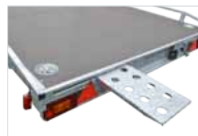
Abnehmbare Auffahrschienen und Schienenschacht unter dem Boden
