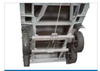
Massive ganzgeschweißte Konstruktion des Anhängers
