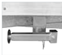
Stützfüsse zur Fixierung des Anhängers beim Beladen
