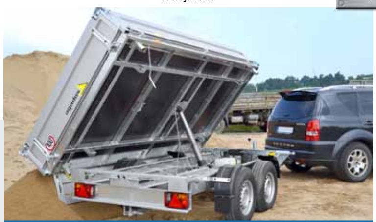
Geschweißter oberer und unterer Rahmen mit Hydraulik
