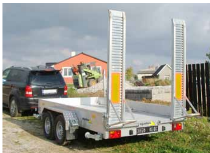
Hinten integrierte Alu-Auffahrschienen
