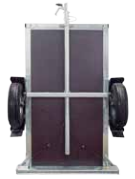
Einfache Lagerung wegen einziehbarer Deichsel
