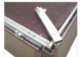
Zurrösen in seitlichen M-Schienen
