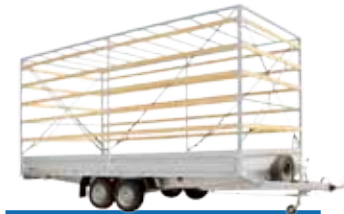
Massives Planengestell, Dachträger demontierbar
