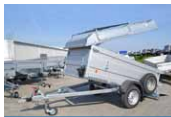
Kippbarer gebremster Anhänger VZ 26 mit Alu-Bordwänden, Bordwandaufsatz, Reserverad und GFK Deckel
