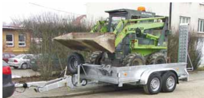
Hinten integrierte Stahl-Auffahrschienen mit hoher Tragfähigkeit
