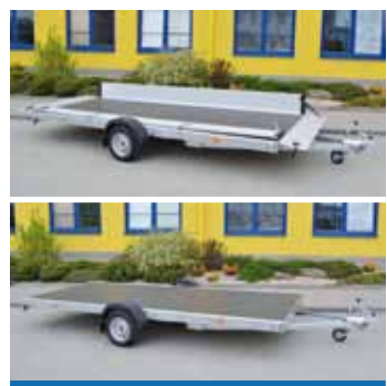
einfache Demontage der Bordwände, Ausführung Plateau
