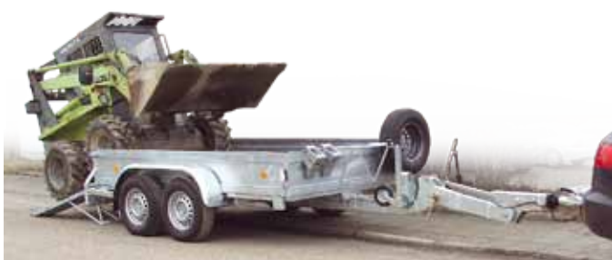
Anhänger VZ 31 Minibagger mit höhenverstellbarer Deichsel mit DIN Zugöse oder Kugekupplung ISO 50
