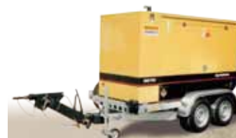
Fahrgestell für Elektrozentrale mit höhenverstellbarer Deichsel
