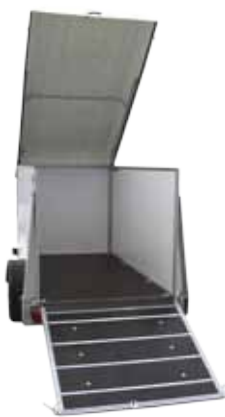
Hintere Rampe mit Möglichkeit der antirutsch Ausführung
