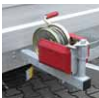
Abnehmbare manuelle Seilwinde mit Halter
