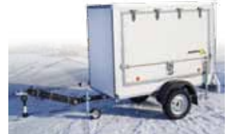
Anhänger VZ 21 Koffer mit Seitenklappe und höhenverstellbarer Deichsel
