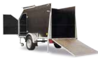
Gebremster Anhänger für Heißluftballon mit Heckrampe und abnehmbarem Dach
