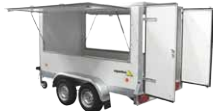
VZ 31 mit Seitenklappen und hinteren Doppelflügeltür
