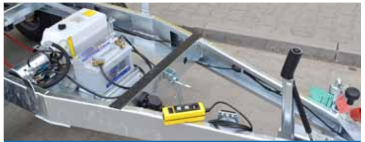
Elektrische Betätigung der Hydraulikanlage mit abnehmbarer Fernbedienung
