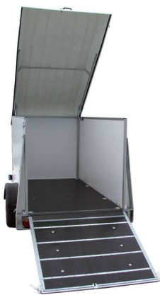
Zadní rampa s možností protiskluzové úpravy
