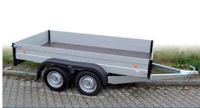
ALUX-31 N2 - dvou nápravové nebrzděné provedení
