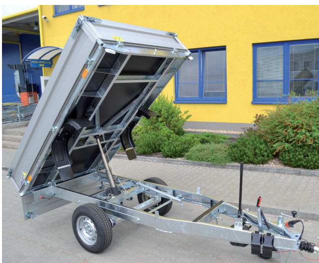
Přívěs Delta B1 s ručním ovládním hydrauliky
