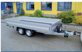
Přívěs DONA se zadními opěrnými nohama a rezervním kolem
