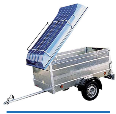
Přívěs NP-3 s nástavbou bočnic a uzamykatelným víkem
