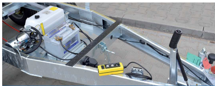
Elektrické ovládní hydrauliky s odnímatelným ovládacím
