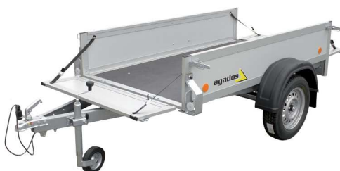
Přívěs VZ-3 Exclusive s předním čelem otevíracím
