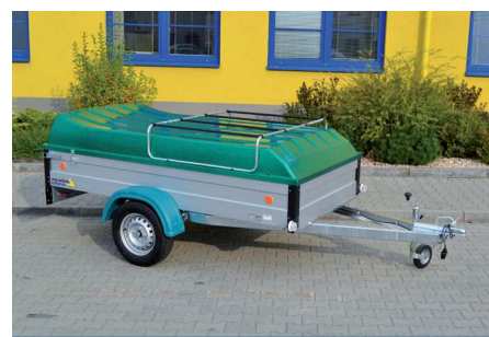
ALUX-26 N1 750 kg s laminátovým víkem
