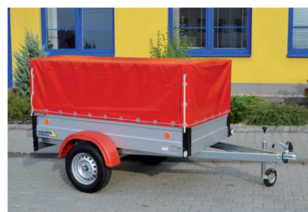
ALUX-3 N1 750 kg s plachtou o ložné výšce 88 cm
