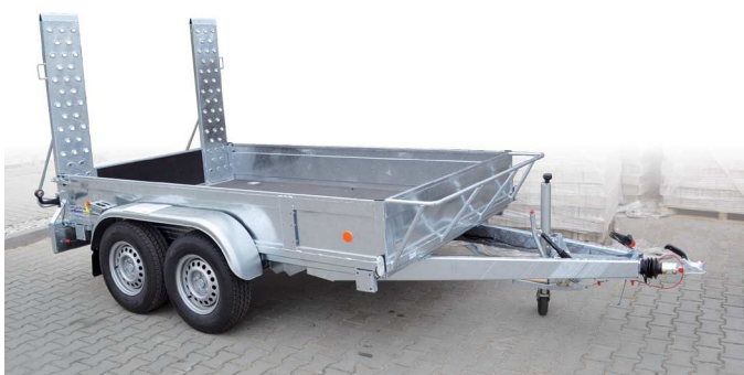
Zadní integrované železné nájezdy s vysokou nosností
