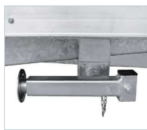
Možnost podpěrných noh pro fixaci privésu při nakládání
