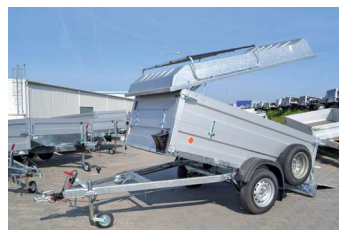
Sklopný brzděný přívěs VZ-26 s hliníkovými bočnicemi, s rezervou, nastavbou bočnic a laminátovým víkem
