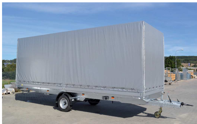
Jednonápravové provedení privésu DANA 3,5t pro nižší mýtné
