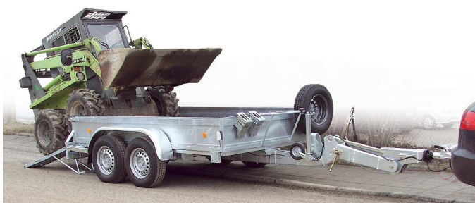
Přívěs BAGR S1 s výškově stavitelnou ojí a možností záměny oka DIN 40 a kloubu ISO 50
