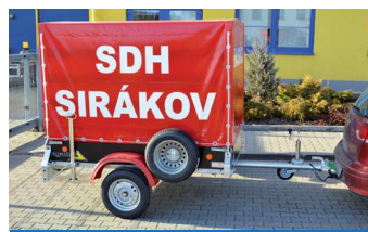
Přívěs VZ-23 s předním čelem otevíracím a plachtou o ložné výšce 1,33 m
