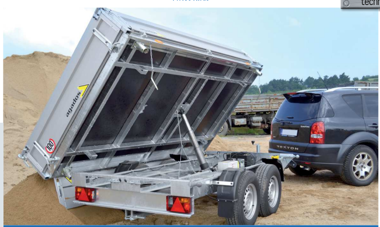
Celosvařený horní a spodní rám se silnou hydraulikou
