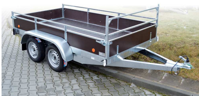
Přívěs VZ-31 N2 - nebrzděné dvounápravové provedení
