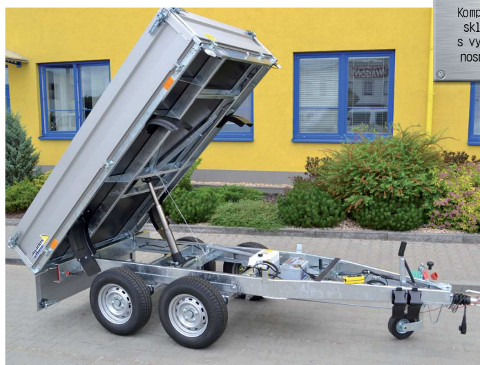
Přívěs Delta B2 s elektrickým ovládním hydrauliky
