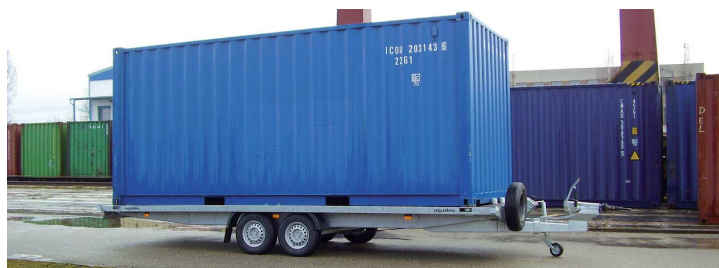
Privěs DONA v úpravě pro převoz prázdných ISO kontejnerů a buněk
