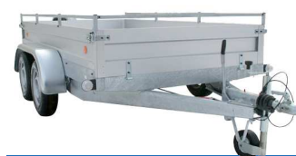
Dvounápravový přívěs VZ-31 B2 s hliníkovými bočnicemi
