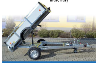
Přívěs VZ-26 B1 s hydraulicky sklopnou korbou
