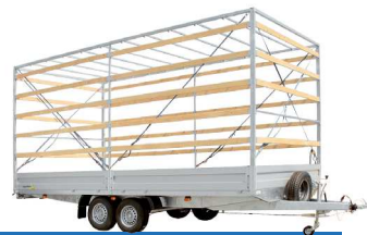
Masivní plachtová konstrukce s odnímatelnými horními příčkami
