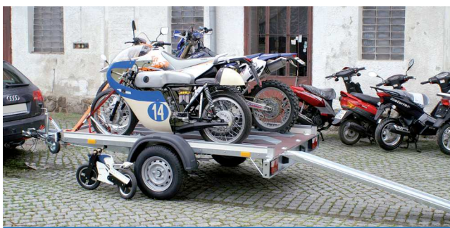
Brzděný přívěs Kangaro-15 B1 pro 3 motocykly
