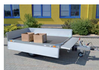
Snadné sklápění hliníkových bočnic
