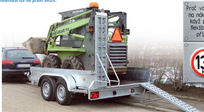
Zadní integrované železné nájezdy s vysokou nosností
