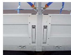
Možnost půlených bočnic s odnímatelným středovým sloupkem
