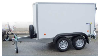
Přívěs VZ-26 B2 s překližkovou skříní
