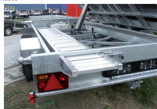
Uschovatelné hliníkové nájezdy ve spodním rámu
