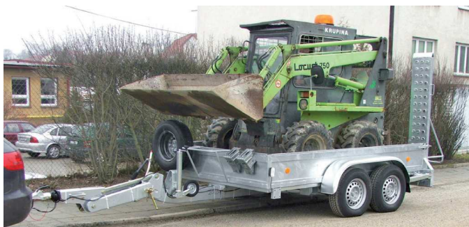
Zadní integrované železné nájezdy s vysokou nosností
