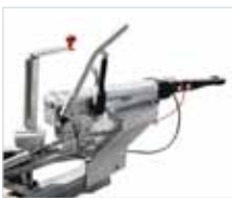
DIN drawbar lug connection device
